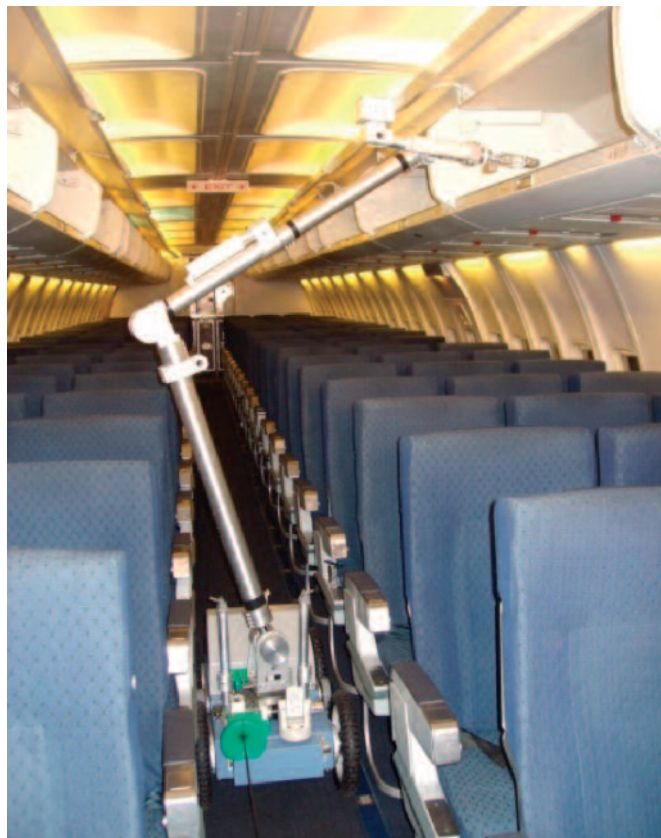
RETRIEVER - mobilný robot pre detekciu vo vnútorných priestoroch lietadiel, vlakov, atď.
